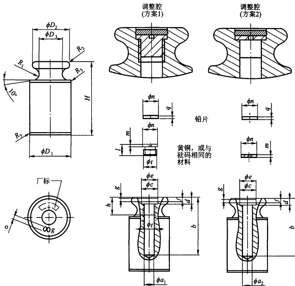
A.2 圆柱体砝码的尺寸表 (单位: 毫米):
