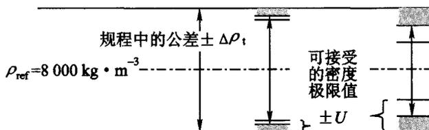
图 2 由测量不确定度产生的密度公差及检定极限图
